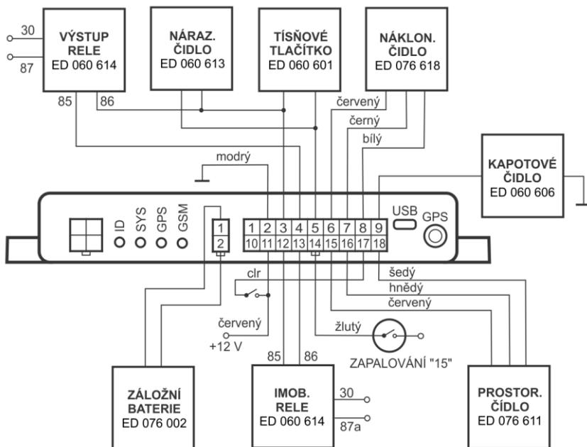
Jednotlivé piny kabeláže a čidel zasuněte do plastové dutinky dle schématu, osazenou dutinku konektoru připojte ke komunikátoru GC 076 232.
