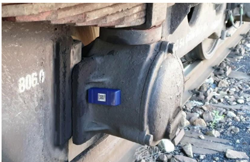
Foto z instalace MS1 na železničním voze
